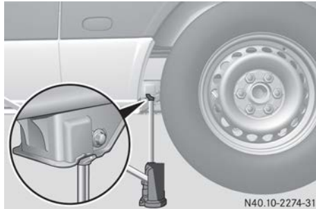
Wagenheber-Aufnahmepunkt, Hinterachse (Beispiel Kastenwagen und Kombifahrzeug 5 t)
