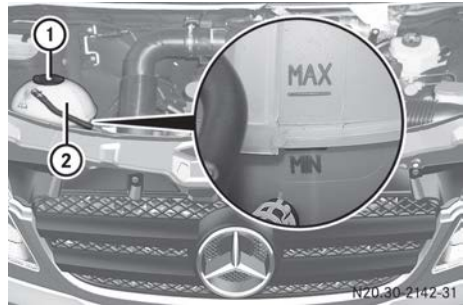
Verschlussdeckel und Kühlmittel-Ausgleichsbehälter (Beispiel)
