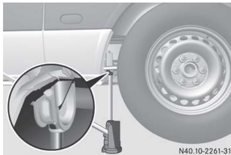
Wagenheber-Aufnahmepunkt, Hinterachse (Beispiel Kastenwagen und Kombifahrzeug bis 3,8 t)
