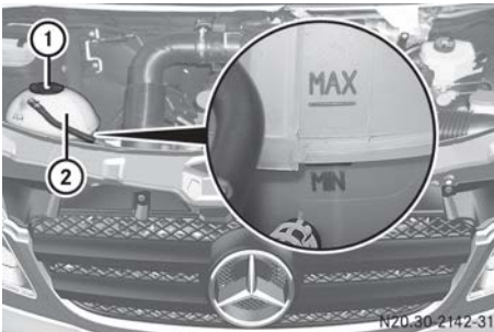
Lokk og kjølevæskens ekspansjonstank (eksempel)
