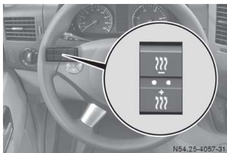
Bilar med varmvattenextravärmare
