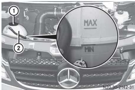
Lock och expansionskärl för kylarvätska (exempel)
